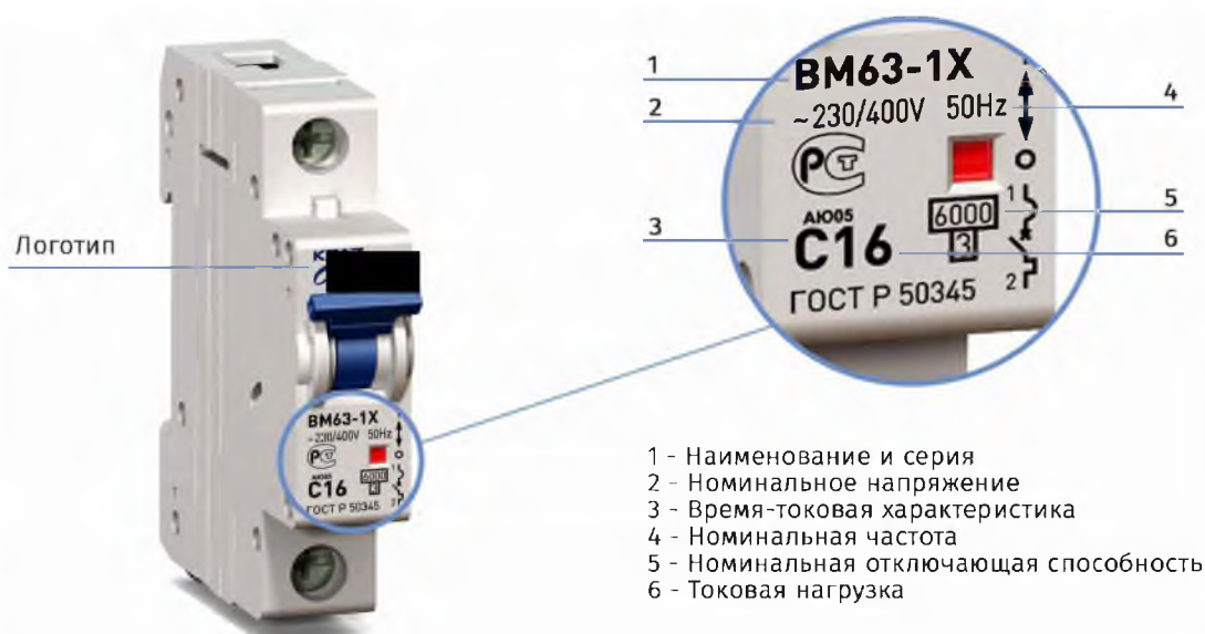
Рисунок 2. Пример маркировки АВ
