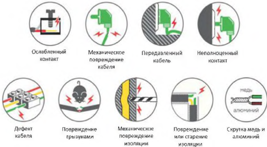
Рисунок 6. Возможные причины искрения в электропроводке
